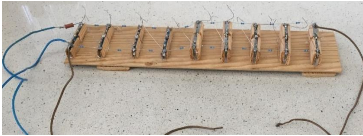
Ryc.1. generator Marxa stosowany w procesach modyfikacji przy pomocy pola elektrycznego
